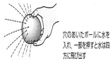
図7 液体の及ぼす圧力の実験
